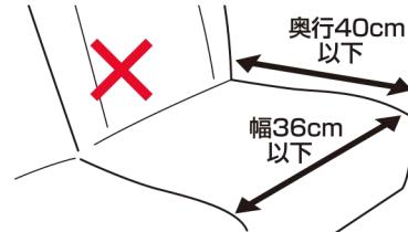
● 座席と本装置の背もたれとの間に大きな隙間ができる座席、または車両のヘッドレストと本装置が干渉して、固定が不安定になる座席。
