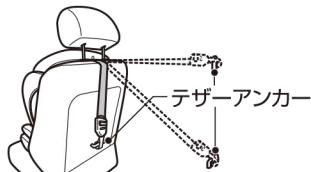
※車両によってテザーアンカーの位置が異なりますので、車両の『取扱説明書』で確認してください。
