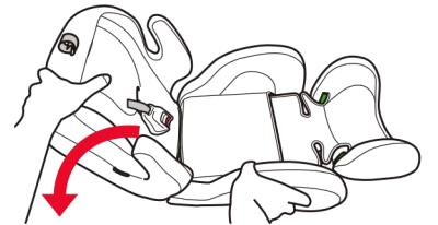
ヘッドサポートカバーは、背面のスナップボタンとベルト通しフックと背もたれの下部に掛かっているゴムを外して、ヘッドサポートカバーを取り外します。
