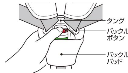
肩ベルトを左右に開き、バックル・バックルパッドを前に倒し、お子様が座れるスペースを確保します。
