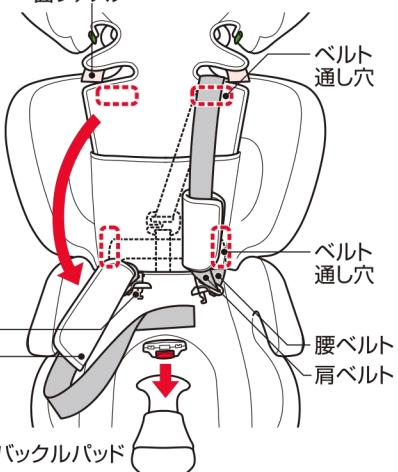
ヘッドサポートを引き上げます。(P17参照)、背もたれを押さえ、座面をゆっくり引き下げ、背もたれと座面を外します。
