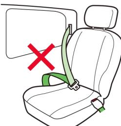
●受け側のバックルベルトの長さが約15cm以上ある。(車両のバックルやタンクが本装置とあたり、しっかりと締め付けができません。)
