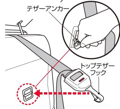
※車両によってテザーアンカーの位置が異なりますので、車両の『取扱説明書』で確認してください。
