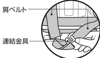
ヘッドサポートの面ファスナーを外して、肩ベルトをベルト通し穴から正面に引き出します。
