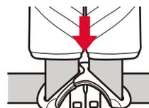
**警告** バックルとタングをセットした際、「カチッ」と音がしたことを確認してください。
