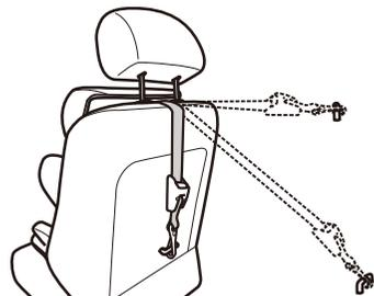
※車両によってテザーアンカーの位置が異なりますので、車両の取扱説明書で確認してください。
