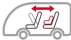
**注意** 取り付ける際は、座席の背もたれを起こしてください。座席のヘッドレストが本装置に当たる場合は、上にあげるか取り外してください。座席の背もたれを、車両のシートベルトの取り付け位置より後方にスライドさせて使用しないでください。
