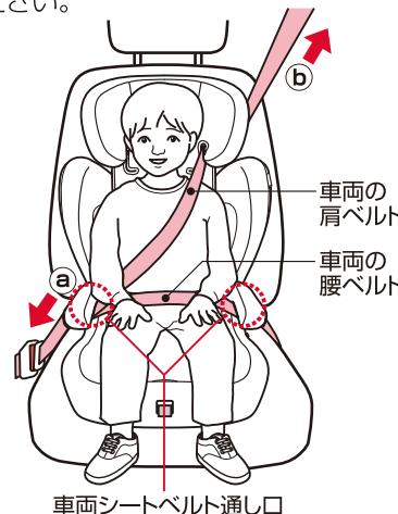
**警告** 車両のバックルとタングをセットした際、「カチッ」と音がしたことを確認してください。
