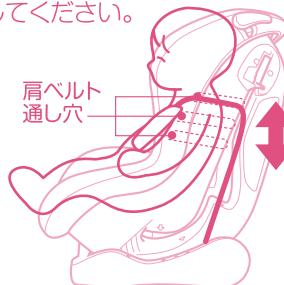
肩ベルトの位置を変更する場合は、肩ベルトを緩め、本装置背面にあるベルト連結金具から、肩ベルトを取り外し、適正な位置の肩ベルト通し穴に通してください。
