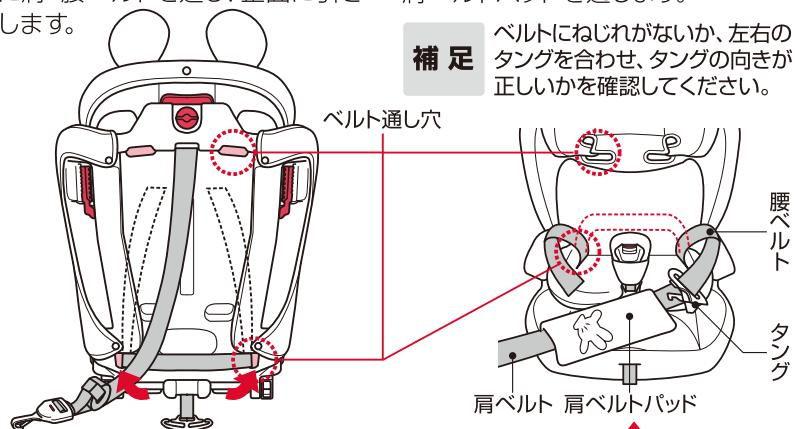
ヘッドサポート調節レバーを上下させて、ヘッドサポートのベルト通し穴と、本体のベルト通し穴の位置を合わせます。
