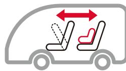
**注意** 取り付ける際は、座席の背もたれを起こしてください。座席のヘッドレストが本装置に当たる場合は、上にあげるか取り外してください。座席の背もたれを、車両のシートベルトの取り付け位置より後方にスライドさせて使用しないでください。
