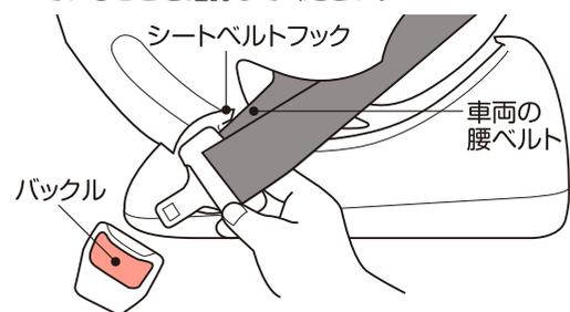
バックルにセットした際、本装置を車両の座席に押し付け腰ベルトを締め付けます。
