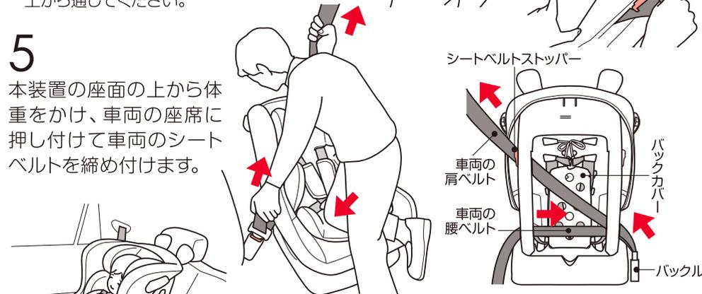
**補足** 車両のシートベルトがバックルに届かない場合、車両の背もたれや座席位置を調整して、再度取り付けてください。
