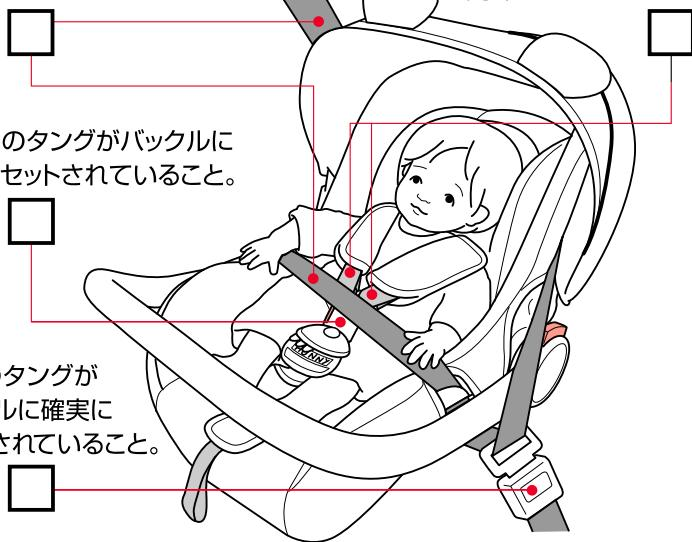
車両のフロア(水平)に対して本装置の背もたれの角度が $45^{\circ}\pm5^{\circ}$ になっていること。この角度を超えて起こした姿勢では呼吸がしづらい場合がありますので角度に注意して設置してください。
