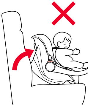
●本装置の本体が車両のシートの背もたれと座面に接するように設置してください。
