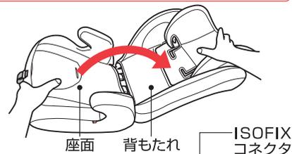
**2** 車両の座席に本装置を置き、ISOFIX取付金具に左右のISOFIXコネクタの位置を合わせ、「カチッ」と音がするまで差し込むとロックされます。さらに、本装置と車両の座席の背もたれとの間に隙間がなくなるまでゆっくり押し込んでください。
