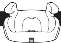
**3** 確実にロックされているか、本体を前後に軽く揺すって確認してください。本装置を車両の座席に置き、ぐらつきがなく安定していることを確認してください。車両の座席の背もたれがリクライニ
