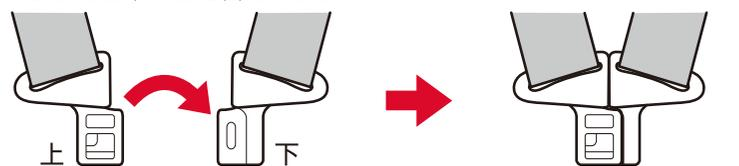
「カチッ」と音がするまで、タングを確実にバックルに差し込みます。
