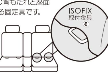
ISO FIX型チャイルドシートの取り付けを認可された座席の車両に取り付けることができます。
