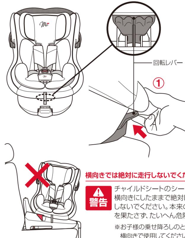
本体正面の下部にある回転レバーを押し上げると、左右どちら側にも回転させることができます。
