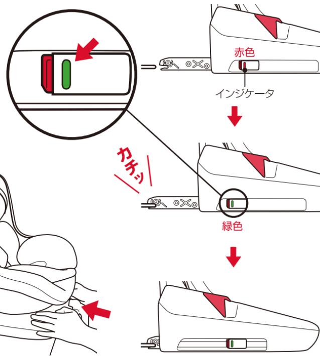
**5.** レッグサポート調節レバーを押してロックを解除し、レッグサポートを上下させて調節します。車両のフロアにしっかりと接地していることを確認して、ロックしてください。
