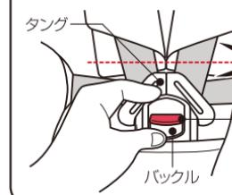
緊急時は慌てず速やかにお子様を救出してください。バックルボタン(赤いボタン)を下に押しても、タンガがバックルから解除できない場合は、本装置のベルトを、はさみ等で切ってお子様を降ろしてください。
