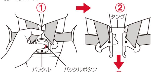
お子様を座らせ、左右の肩ベルトを掛け、タングを合わせ、バックルが「カチッ」と音がするまで差し込みます。
