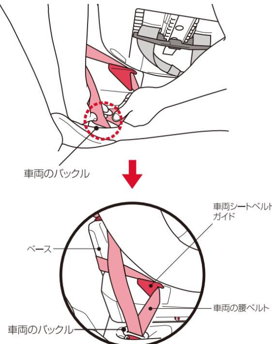
**5.** 本装置を車両の座面に押しつけながら車両の肩ベルトを強く引き上げて、車両の腰ベルトをしっかり締め付けてください。
