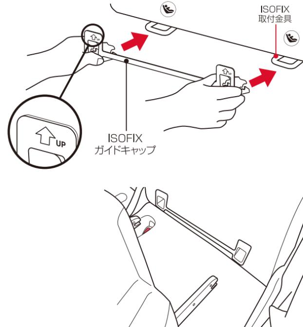
**4.** レッグサポートをベースの手前に引き出し(P16 参照)、車両の座席に本装置を置き、ISOFIX取付金具に左右のISOFIXコネクタが「カチッ」と音がするまで差し込むとロックされます。
