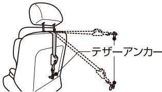
※車両によってテザーアンカーの位置が異なりますので、車両の『取扱説明書』で確認してください。
