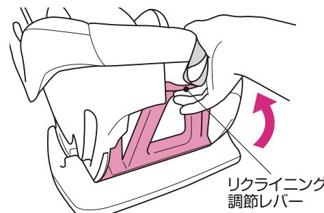
リクライニング調節レバーを持ち上げながら本体をスライドさせ、リクライニングガイドマーク▲(前向き3段階・後ろ向き1段階)を適正な位置に合わせてください。
