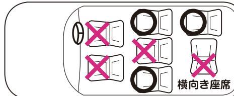
●助手席にはエアバッグが装備されています。エアバッグの作動により大きな衝撃を受けるおそれがあるため、必ず**後部座席に取り付けてください。**
