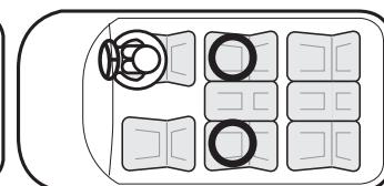
※助手席のエアバッグスイッチをオフにする機能がある車両については、助手席のエアバッグをキャンセルすることを条件に、助手席に本装置の取り付けが可能な場合がありますが、より安全な後部座席に装着してください。
