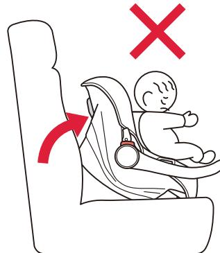
●本装置の本体とハンドルが車両のシートの背もたれに接地するように、底面がぐらつかないようにしっかりと設置させてください。
