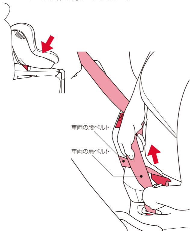
6. 腰ベルトを締め付けた状態で、車両の肩ベルトに緩みがないように強く引き上げて、ベースの上部にある車両シートベルトフックに通し、ロックします。
