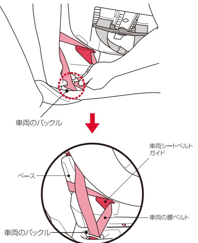
5. 本装置を車両の座面に押しつけながら車両の肩ベルトを強く引き上げて、車両の腰ベルトをしっかり締め付けてください。
