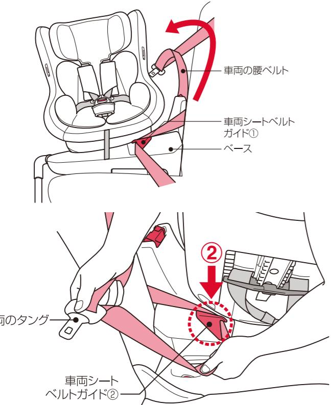
4. 車両のバックルに、タングをセットします。
