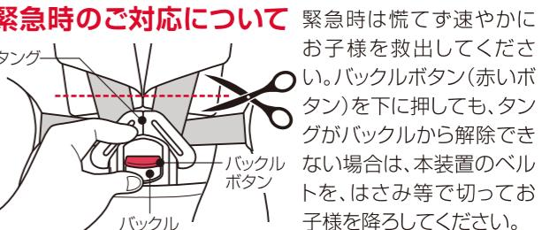
緊急時は慌てず速やかにお子様を救出してください。バックルボタン(赤いボタン)を下に押しても、タンクがバックルから解除できない場合は、本装置のベルトを、はさみ等で切ってお子様を降ろしてください。
