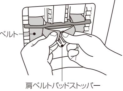
④肩ベルトパッド(内側)の面ファスナーを付けて、肩ベルトパッドを取り付けます。
