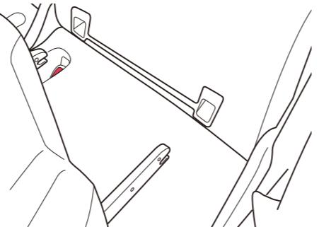
4. レッグサポートをベースの手前に引き出し(P16参照)、車両の座席に本装置を置き、ISOFIX取付金具に左右のISOFIXコネクタが「カチッ」と音がするまで差し込むとロックされます。
