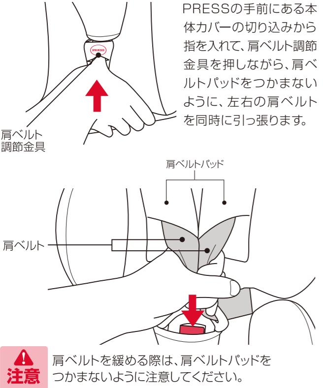
2. バックルボタン(赤い部分)を下に押して、タングをバックルから解除します。
