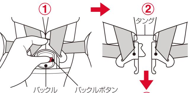
お子様を座らせ、左右の肩に肩ベルトを掛け、タングを合わせ、バックルが「カチッ」と音がするまで差し込みます。
