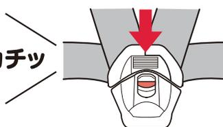
**警告** バックルとタングをセットした際、「カチッ」と音がしたことを確認してください。
