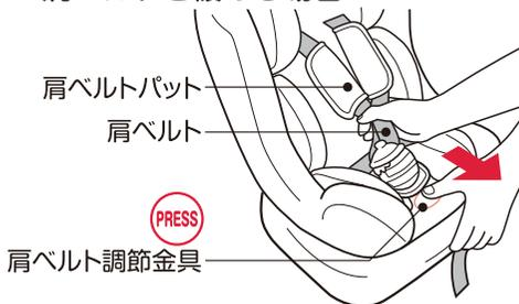
**注意** 左右の肩ベルトの長さが均等になるように、左右の肩ベルトを同時に引き出してください。
