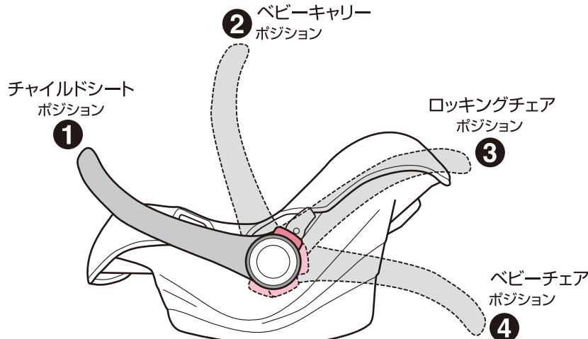
ハンドルの付け根の左右にあるハンドルボタンを同時に押しながら、ハンドルを使用するポジションに回転させます。
