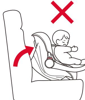
●本装置の本体が車両の背もたれと座面に接するように、設置してください。
