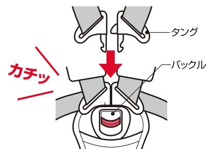
左右のタングを合わせ、バックルに、「カチッ」と音がするまで確実に差し込み、バックルパットを引き上げます。
