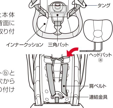
ヘッドパット⑥をヘッドパット⑤と本体カバーの肩ベルト通し穴から背面に通し、ヒモで結んで取り付けます。
