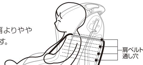
肩ベルトの位置を変更する場合は、肩ベルトを緩め、本装置背面にある連結金具から肩ベルトを取り外し、適正な位置の肩ベルト通し穴に通します。
