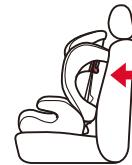
本装置と車両の背もたれ・座席との間に隙間がないようにする。
