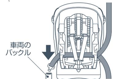
**注意** 車両のバックルに確実にロックされていることを確認してください。
