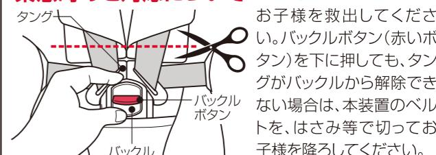
緊急時は慌てず速やかにお子様を救出してください。バックルボタン(赤いボタン)を下に押しても、タンクがバックルから解除できない場合は、本装置のベルトを、はさみ等で切ってお子様を降ろしてください。
