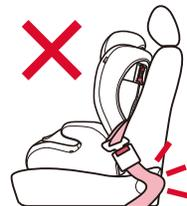
●極端なバケットシート。座面・背面が極端に凹んだ座席。または座面の凹凸が大きく、不安定な座席。
