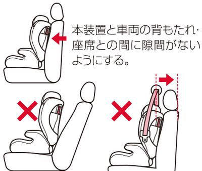
本装置と車両の背もたれ・座席との間に隙間がないようにする。
