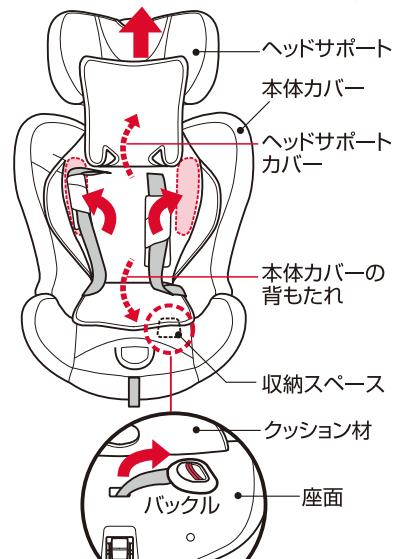
バックルカバーを外したバックルを、本体力バーとクッション材をめくって、座面の収納スペースに収納します。
