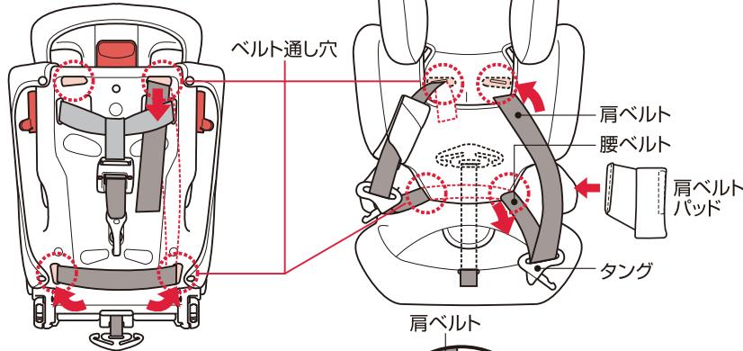
肩ベルトを上側のベルト通し穴から本体背面に通します。
