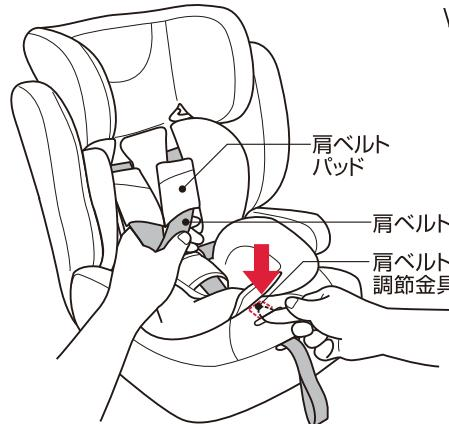
**注意** 左右の肩ベルトの長さが均等になるように、左右の肩ベルトを同時に引き出してください。
