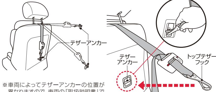
※車両によってテザーアンカーの位置が異なりますので、車両の「取扱説明書」で確認してください。
