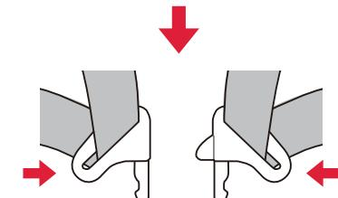
タングをバックルに「カチッ」と音がするまで確実に差し込み、バックルパッドを引き上げます。
