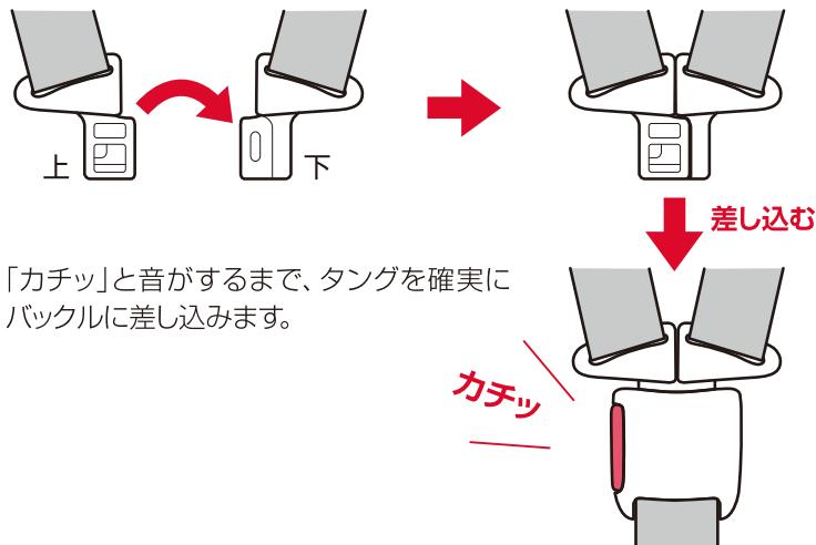
「カチッ」と音がするまで、タングを確実にバックルに差し込みます。
