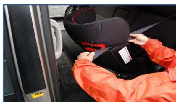
車両の肩ベルトを装置の〈ベルト通しフック〉に通す。
