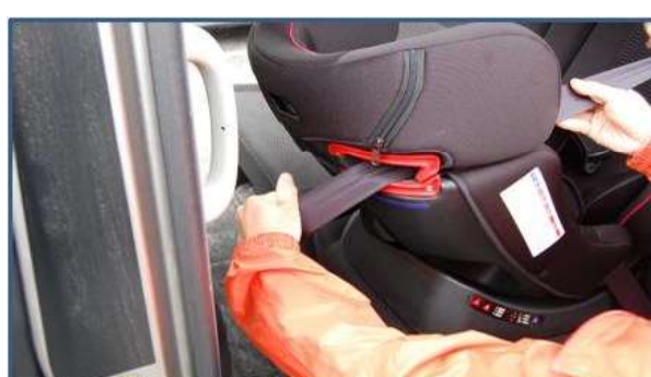
車両の肩ベルトを装置の〈ベルト通しフック〉に通す。
