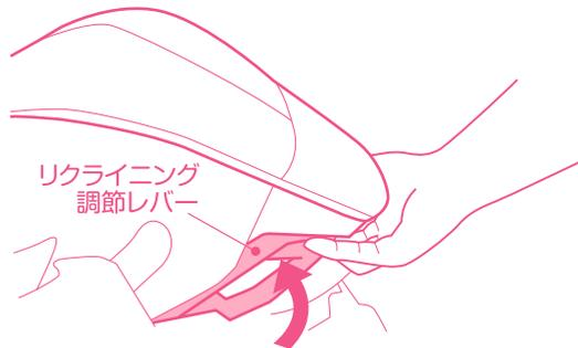
リクライニング調節レバーを押し上げながら本体をスライドさせ、リクライニングガイドマーク▲（前向き3段階・後ろ向き1段階）を適正な位置に合わせてください。リクライニング調節レバーを離すと、本体がロックされます。
