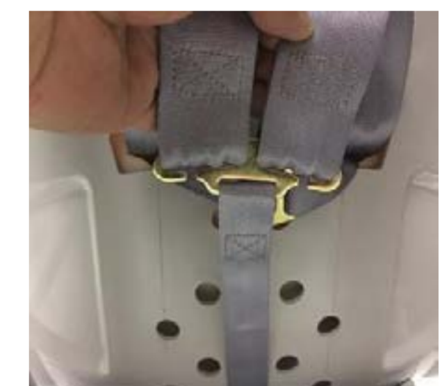
12:肩ベルトをベルト連結金具に左右取り付けます。(肩ベルトの作動確認をしてください) ※ねじれがないようにしてから、取り付けてください。
