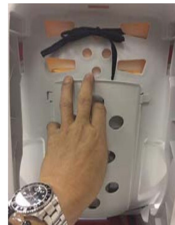
13:バックカバーを取り付けます。 (上2箇所、下側2箇所)
