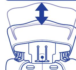
ヘッドサポート調節取っ手を引いて上下にスライドさせ、お子様の頭の高さ(ヘッドサポートに頭が収まっている位置)に合わせてください。
